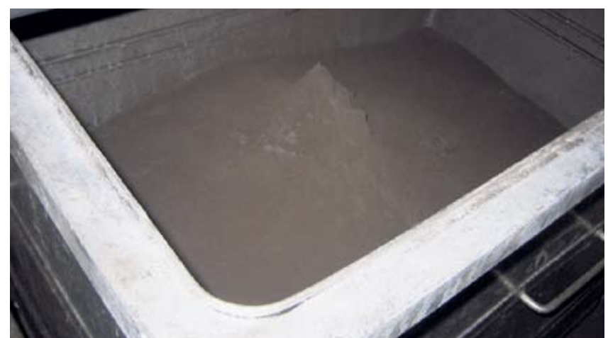
Gut versorgt im Container: Feinstaub aus dem Elektrofilter. Bild: Nadin Bill
